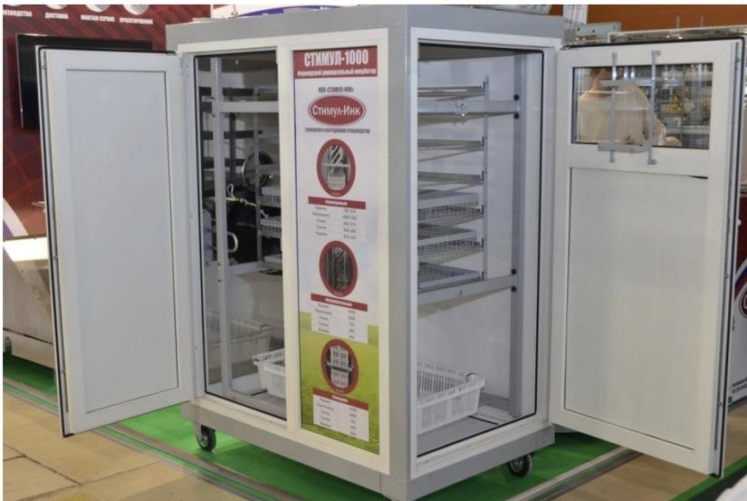
Шкафный тип устройства имеет два отделения, предназначенных для инкубации яиц и вывода молодняка. Модель оснащена: поворотом лотков на 45 градусов от плоскости (автоматическим); системой водного охлаждения с помощью форсунки, установленной на потолке камеры; системой вентиляции. После того как задана программа — агрегат работает в автоматическом режиме. Контроль за процессом ведётся при помощи датчиков. Имеется система защиты от перегрева. Линейка инкубаторов выпущена НПО «Стимул-Инк».
